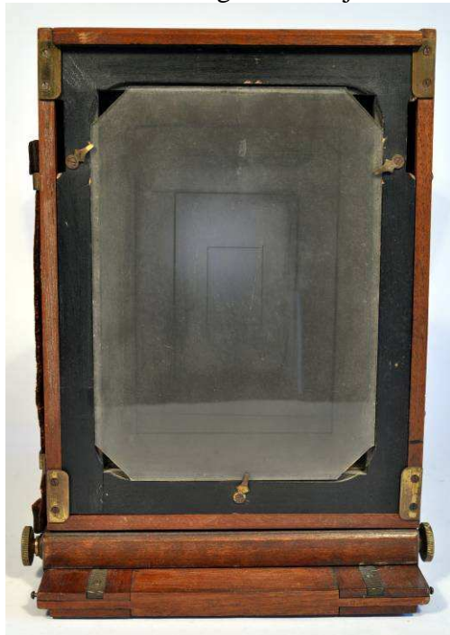
Matglaspladen. Læg mærke til de afklippede hjørner og blyantsstregene.
