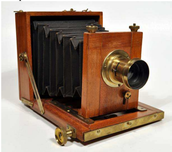
Fast bagstykke og forskydelig front (engelsk kamera).
