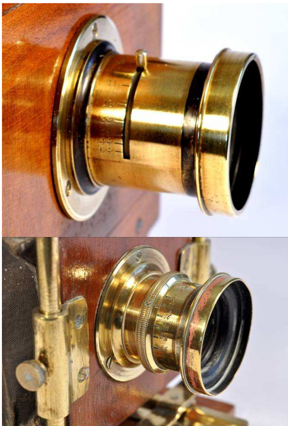
To eksempler på objektiver med irisblænder.
