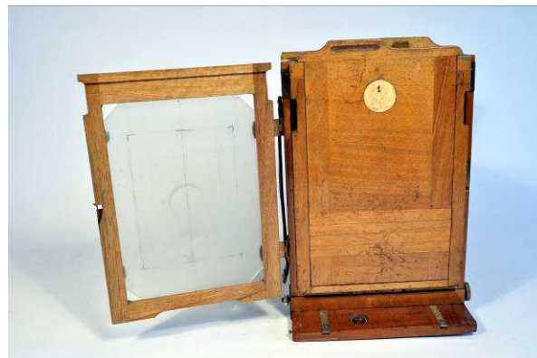
Matskiven skudt til side og pladekassetten indsat.
