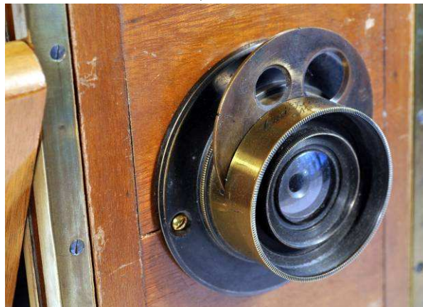
Objektiv med revolverblænder.
