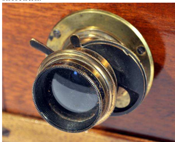
Objektiv med indbygget rotationslukker.
